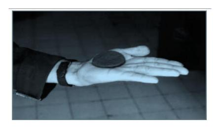
Foto 2.1 Formación de pastilla para la prueba de dilatancia
