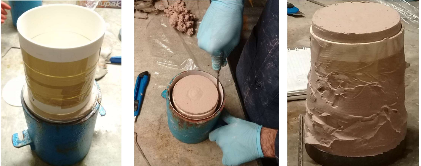
Figura 3.12. Hincado de anillos de pvc dentro de la muestra pre-consolidada.
