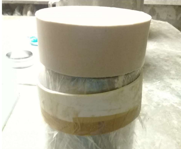
Figura 3.26. Extracción de muestra de anillo de pvc.
