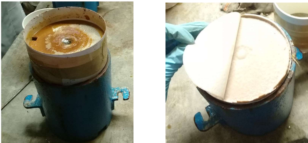
Figura 3.11. Muestra ya pre-consolidada desmontada del consolidómetro gigante.
