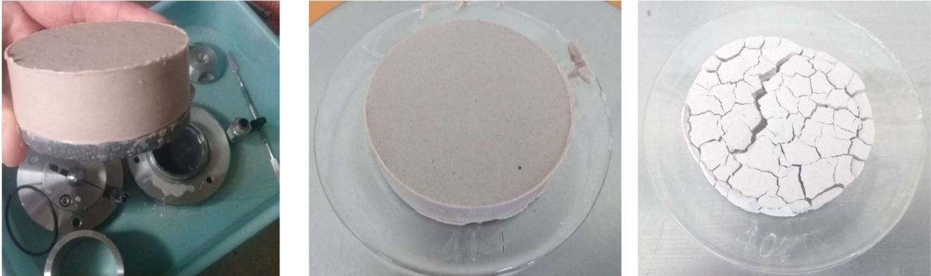
Figura 3.32. Desmonte y obtención de contenido de agua posterior al ensaye.
