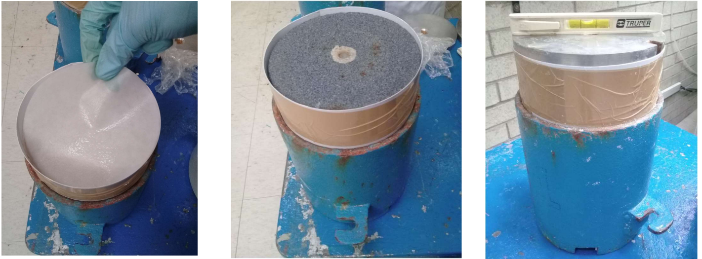
Figura 3.6. Colocación de papel filtro, piedra porosa y placa metálica.
