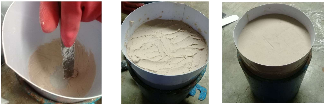
Figura 3.5. Llenado del molde con ayuda de espátula, nivelado y enrasado.
