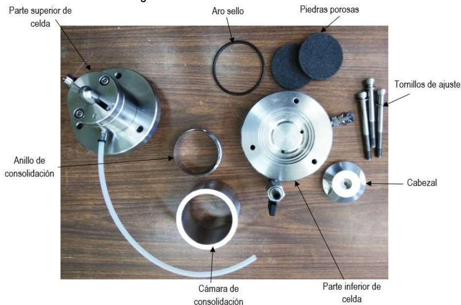
Figura 3.19 Celda de consolidación desmontada.
