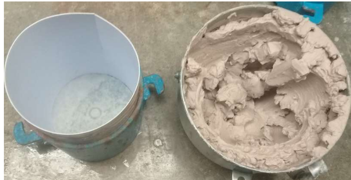
Figura 3.4. Molde con piedra porosa inferior, papel filtro y lámina plástica. Mezcla lista para colocarse.
