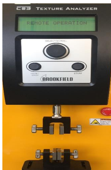
Figura 16 A) Equipo Texture Analyzer CT3 Brookfield® B) Colocación de la muestra para medir tensión a la rotura (TR) utilizando el accesorio TA-DGF.
