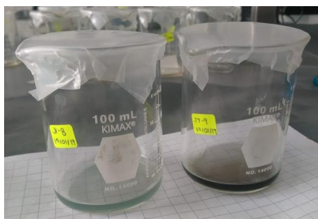
Figura 18. Mezclas de reacción después de 24 h para la transferencia de hidrógeno catalizada por los compuestos 3 (izquierda) y 4 (derecha).
