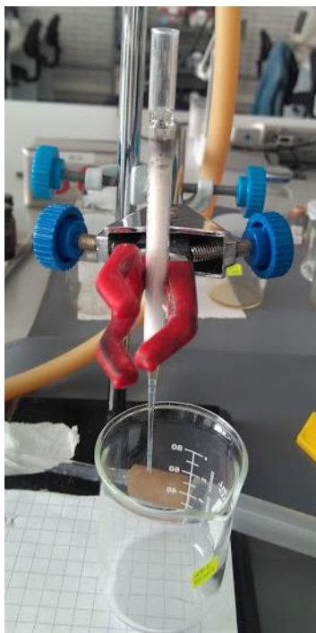
Figura 19. Cromatografía en columna. Separación de los productos de la reacción catalítica.
