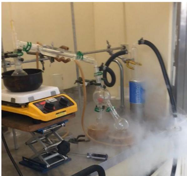
Figura 42. Proceso de destilación a presión de vacío del 1-vinilimidazol
