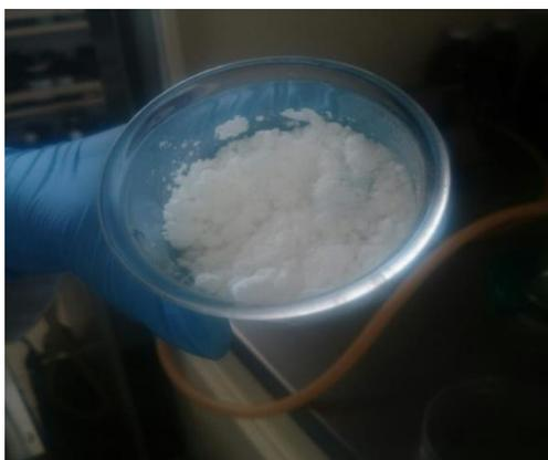
Figura 41. Cristales de NIPAAm purificados mediante recrystalización.
