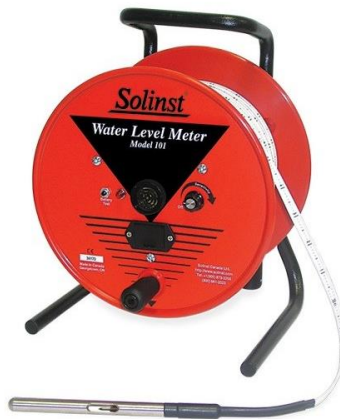
Foto 7. Sonda eléctrica o piezométrica.
