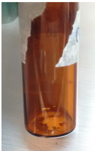
Figura 25. CuSCN precipitado después de recuperar el material disuelto.
