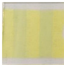
Figura 31. Película de CdS por CBD con pH=11.02, depositada a una temperatura de 80°C durante 30 min.
