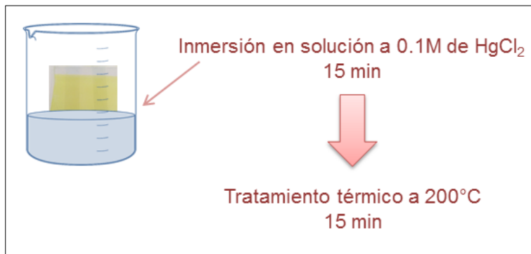
Figura 19. Proceso de impurificación de CdS con \text{HgCl}_2 .
