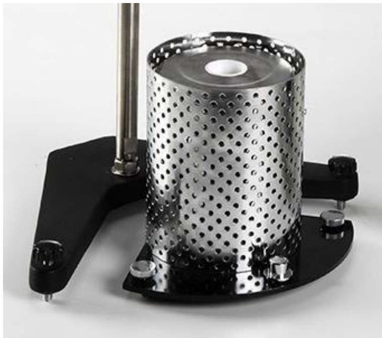
Figura 23. Calentador de tubos regulado a 180 °C.
