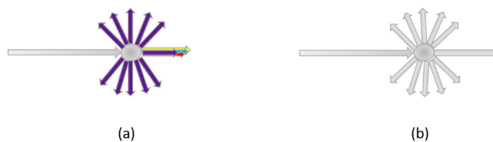
Figura 2.12 (a) Esparcimiento de Rayleigh : Para partículas menores a la longitud de onda incidente la luz se separa emitiendo distintas longitudes de onda; (b) Esparcimiento de Mie: Para partículas mayores que la longitud de onda incidente la luz no suele separarse emitiendo la misma longitud de onda incidente
