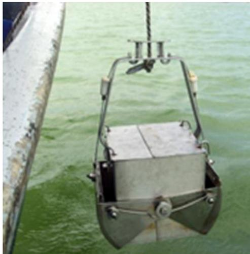
**Fig. 2.** Draga tipo Ekman utilizada para la obtención de sedimentos superficiales.
