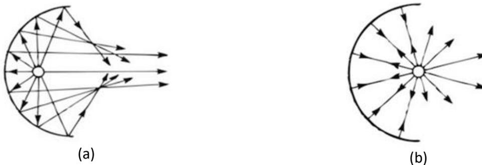
**Figura 3.1.** (a) Reflector Circular con fuente de luz desplazada a la izquierda. (b) Reflector Circular con fuente de luz en el centro de la circunferencia.
