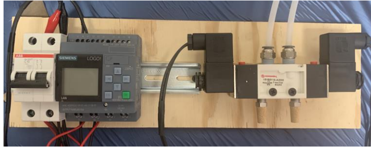
Figura 9. PLC y solenoide con válvula 5/4.
