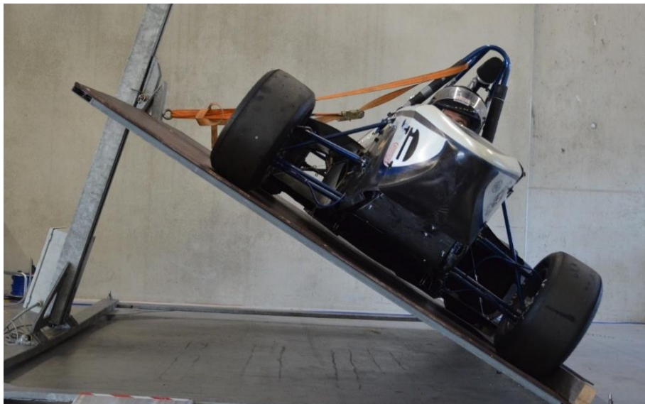
Figura 1.1. Prueba estática de inclinación del prototipo UM-248 en FSA 2017
