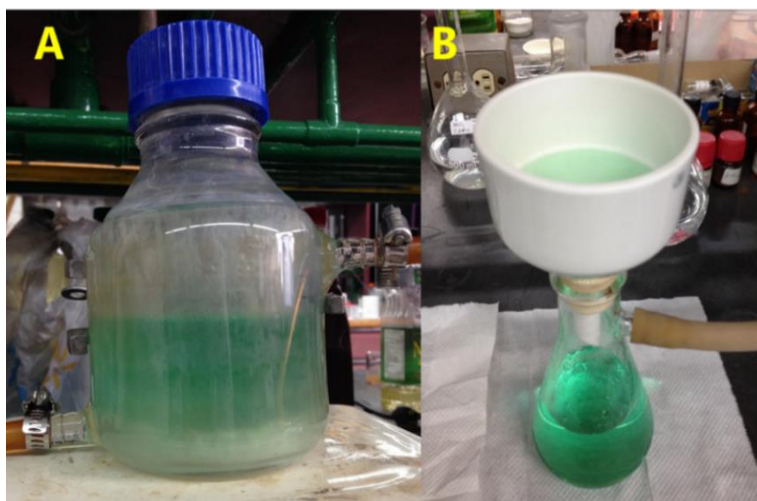
Fig. 32. A) Preparación del catalizador por DP con hidrólisis de urea en un reactor de doble pared y B) recuperación del sólido por filtración.
