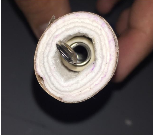
Figura 4.9. Envoltura aislante de papel de alúmina en la muestra de tubo cerámico.
