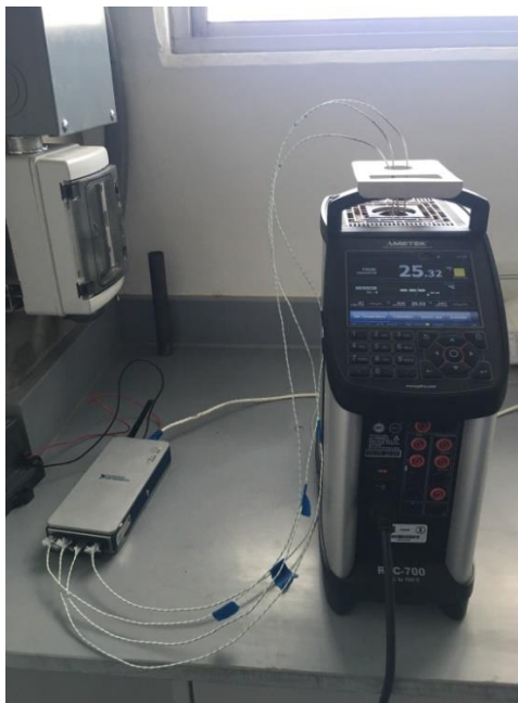
Figura 4.7. Arreglo experimental de calorimetría dT-History.
