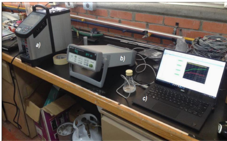
Figura 4.22. Arreglo experimental T-History para bajas temperaturas. a) Calibrador Térmico Jofra. b) Adquisidor de Datos Agilent. c) Computadora personal
