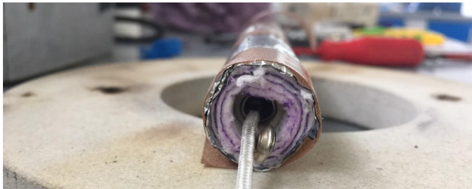
Figura 4.11. Termopar T_{p1} colocado en el arreglo de resistencia-tubo cerámico-envolvente aislante.
