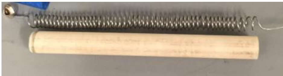
Figura 4.8. Muestra utilizada para la caracterización del tubo contenedor cerámico y la resistencia eléctrica utilizada.
