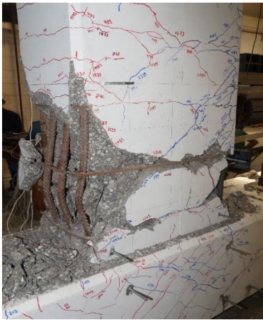
a) Specimen 1 ( w_c=5 mm)
