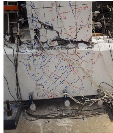
c) Specimen 3 ( w_c=8 mm)
