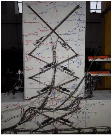
e) Specimen 5 ( w_c=3 mm)
