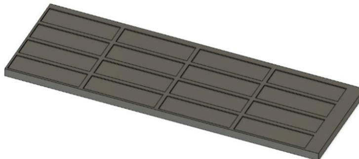
FIGURA 3.8: Estructura de cavidades cuadradas para evaluar la rugosidad.
