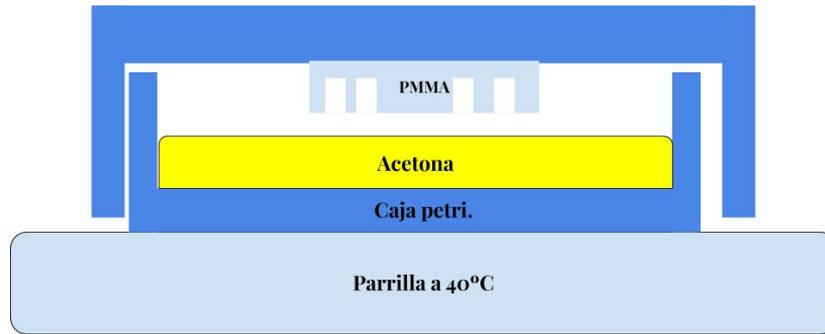
FIGURA 3.30: Arreglo para aplicar un tratamiento con vapor de acetona a 40°C para pulir el PMMA (El PMMA puede sostenerse empleando un trozo de cinta doble cara o un par de imanes, uno sobre el PMMA y otro sobre la caja petri).
