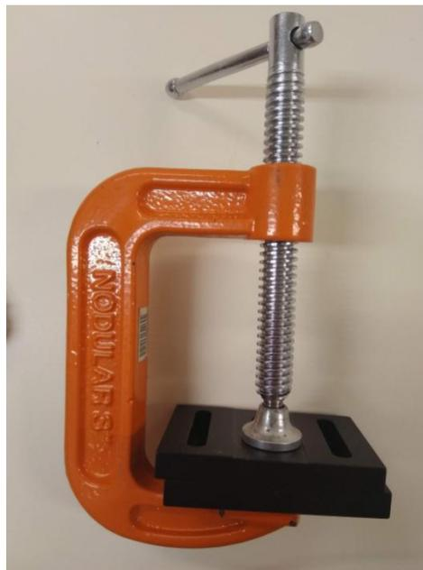
FIGURA 3.35: Prensa de tornillo para aplicar presión.
