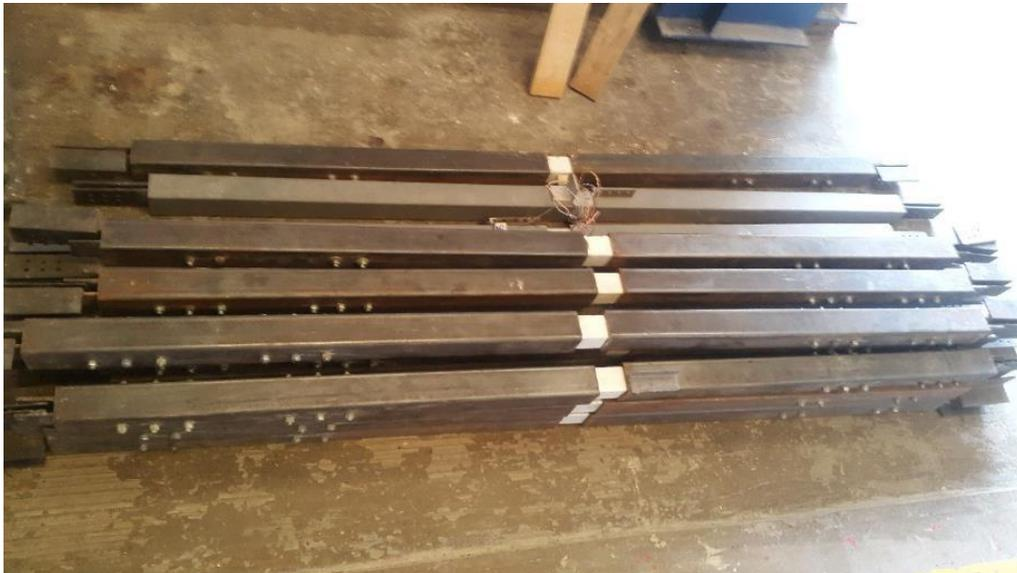
**Figura 3.9** Contraventeos ensamblados
