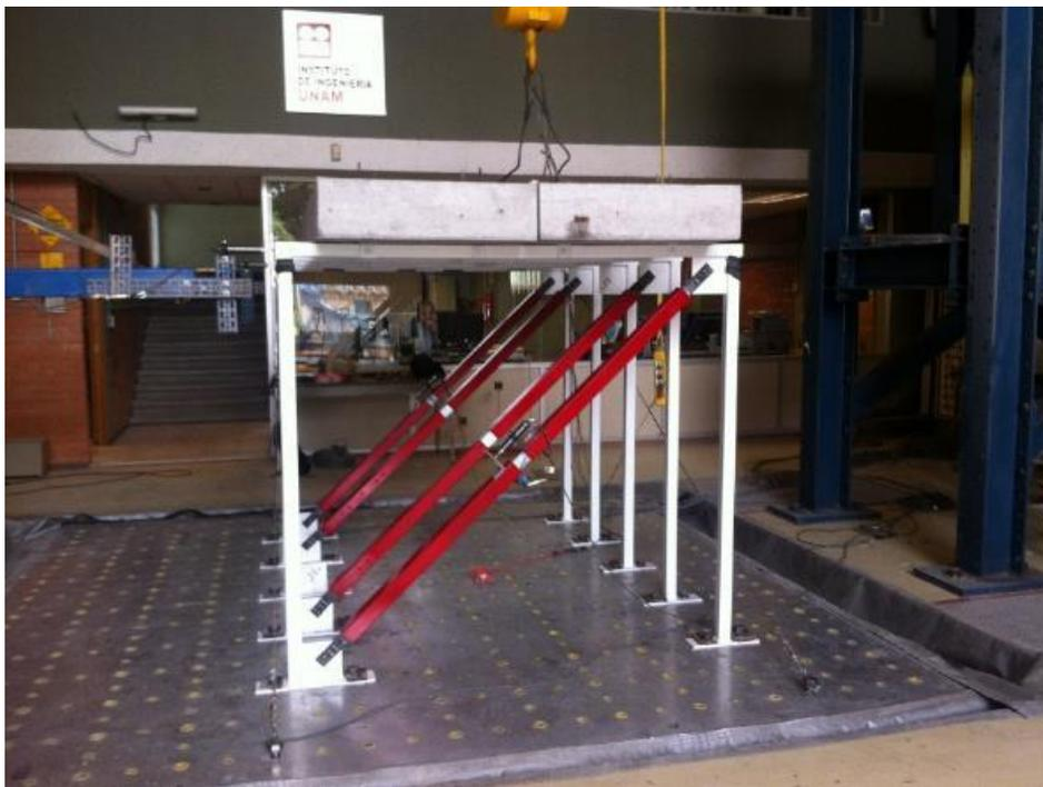
**Figura 5.19** Prueba con cuatro CRPs (prueba 7).
