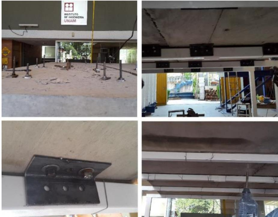
**Figura 3.7** Fijación de losas de concreto en marcos de acero.
