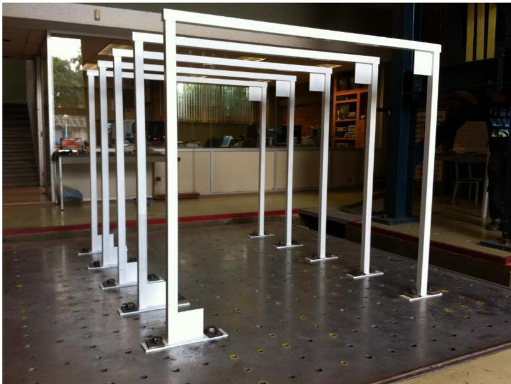
**Figura 3.3** Modelo colocado en plataforma de la mesa vibradora.
