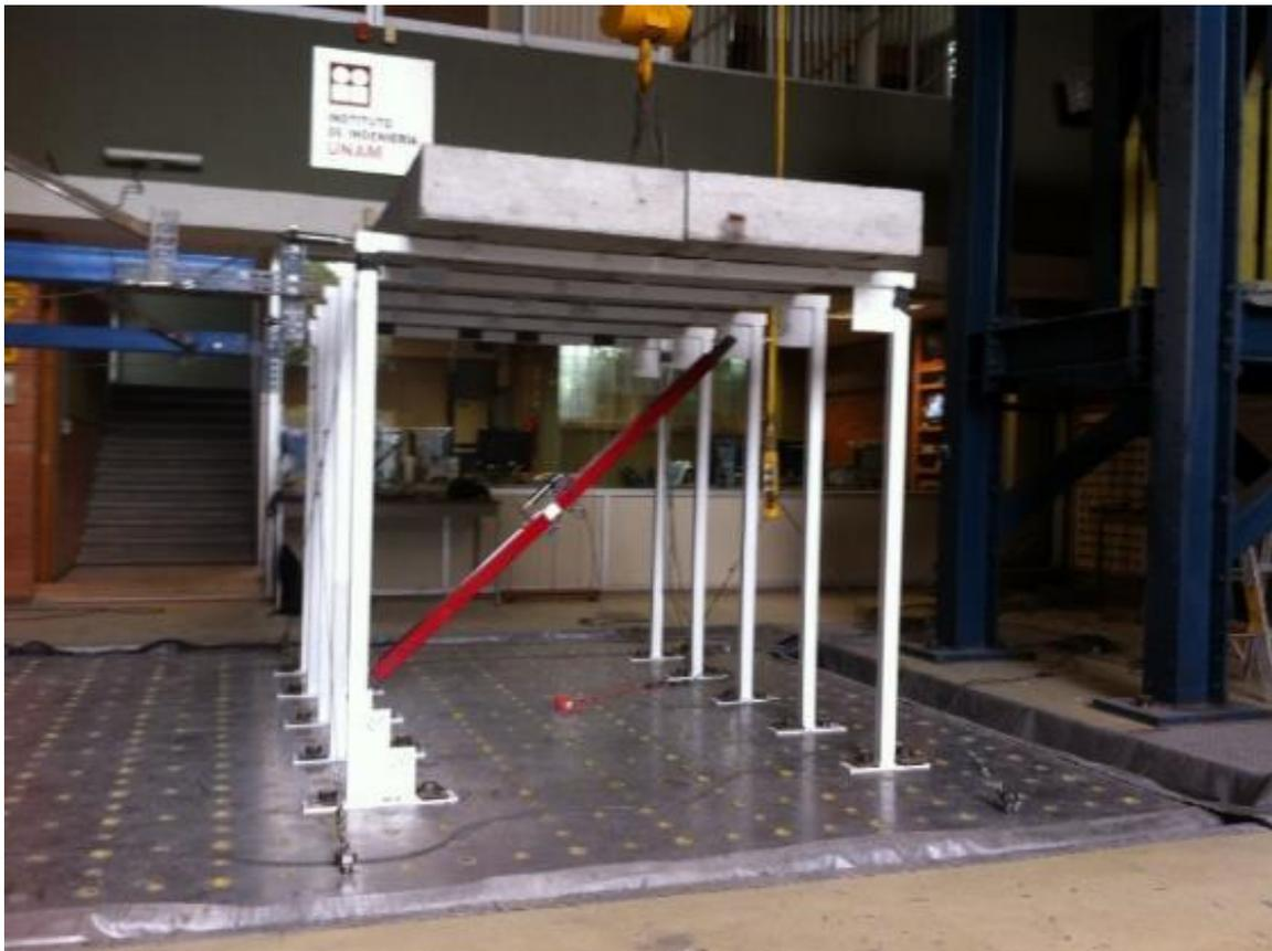
**Figura 5.7** Prueba con un CRP (Prueba 3).
