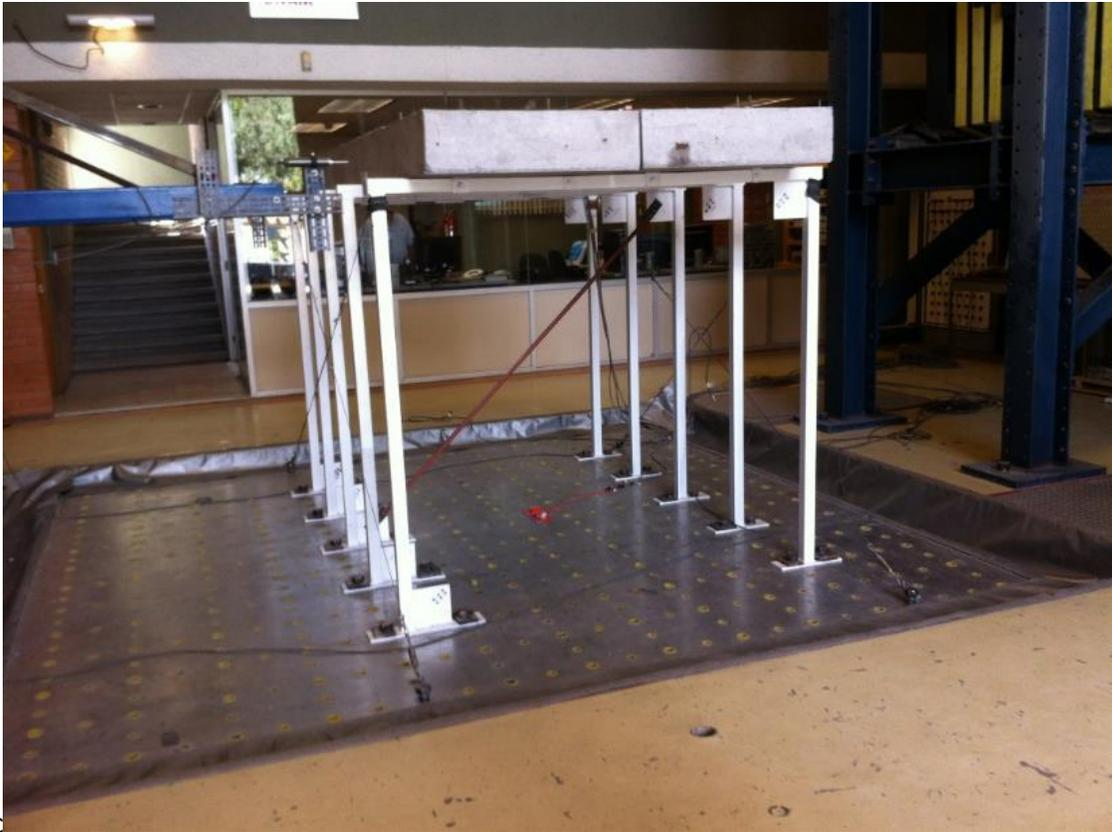
**Figura 5.4** Modelo con contraventeo convencional
