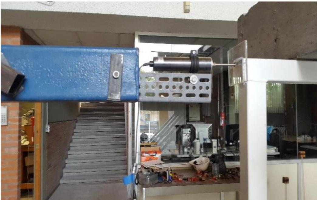
**Figura 4.5** LVDT en una de las esquinas de uno de los marcos.
