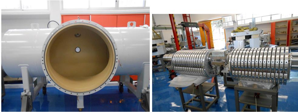
Figura 2.5: Fotografía del tanque que encierra el acelerador tándem de 1 MV y del tubo acelerador.
