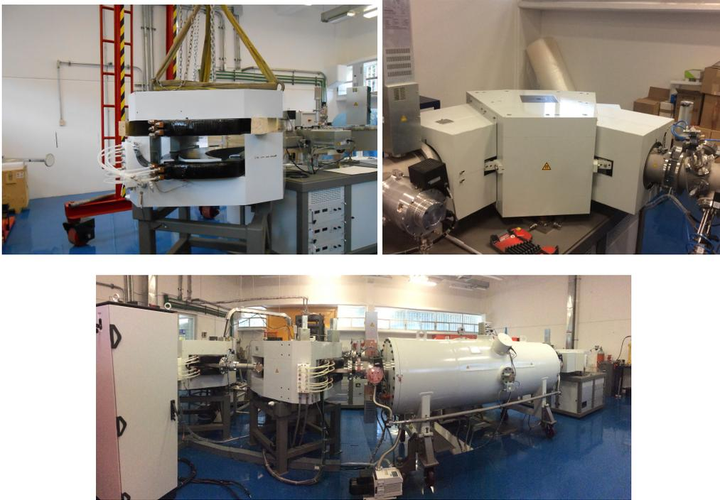
Figura 2.4: Fotografías de los imanes. En la parte superior de la fotografía se encuentra el imán de alta energía antes de ser ensamblado y la vista del imán de baja energía. En la parte inferior se encuentra la vista trasera de los imanes.
