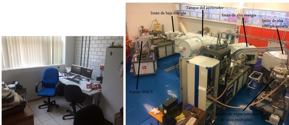
Figura 2.1: Figura actual del LEMA, en la izquierda se encuentra la cabina de control y en la derecha un esquema general de las componentes del laboratorio.
