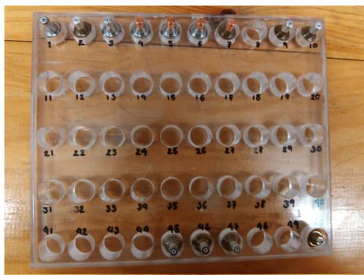
Figura 4.5: Clasificación y orden de los cátodos antes de ser ingresados a la fuente de iones para realizar su caracterización, en la parte superior se encuentran los cátodos nuevos y en la parte inferior cátodos ya usados.
