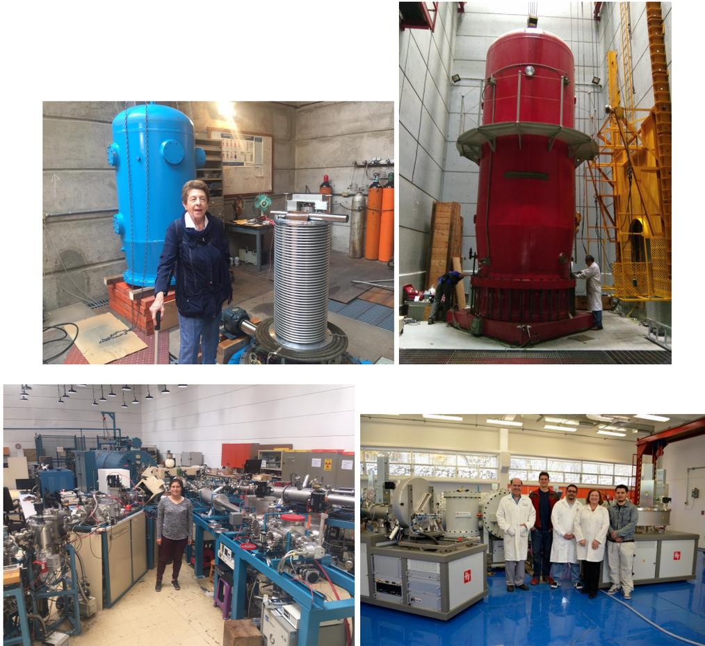
Figura 1.3: Aceleradores en el IFUNAM. En la parte superior izquierda se encuentra el acelerador de electrones Van de Graaff AN2000, en la parte superior derecha el acelerador de iones positivos Van de Graaff CN, en la parte inferior izquierda una vista desde las líneas de experimentación del laboratorio en donde se encuentra el acelerador Peletron 9DSH-2 y finalmente en la parte inferior derecha el LEMA recién instalado en 2013.
