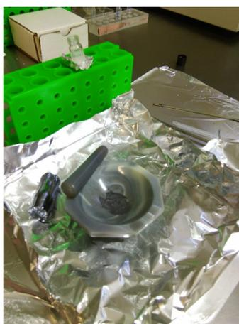
Figura 4.3: Cristal usado para generar el cátodo de Si con pureza del 99.998%.
