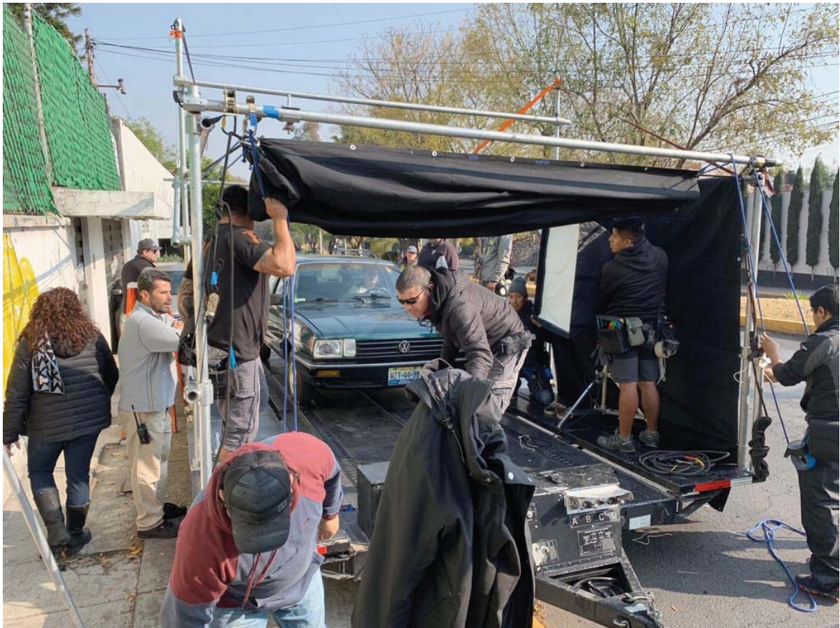
Fotografías de cámara car y low boy montados en calle para filmación de carro en movimiento.
