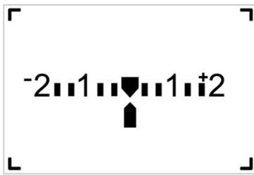
Imagen 25. Exposímetro mostrado en el visor de cámara
