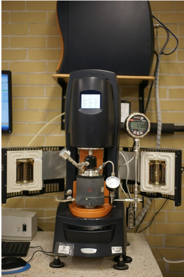
Figura 17. Reómetro TA DHR-3 utilizado para la realización de las pruebas de reología.
