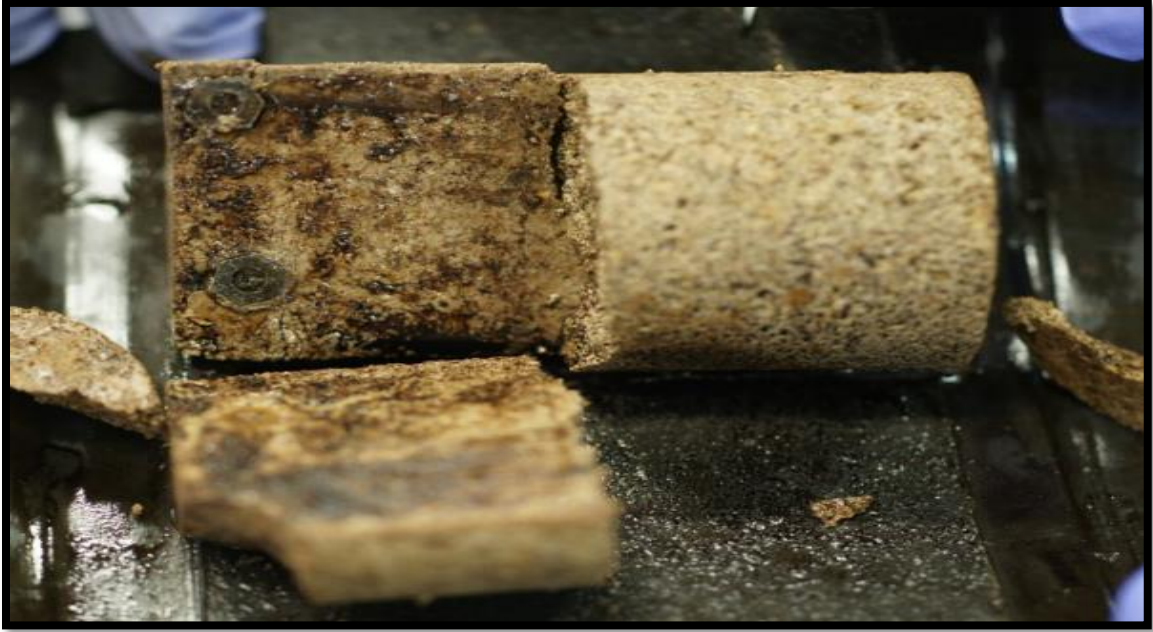
Figura 42. Parte de la fractura del núcleo con residuos de gel.
