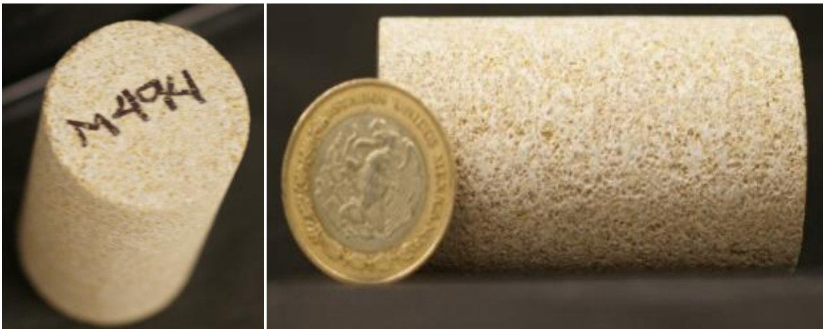
Figura 11. Núcleo utilizado para las pruebas de desplazamiento.
