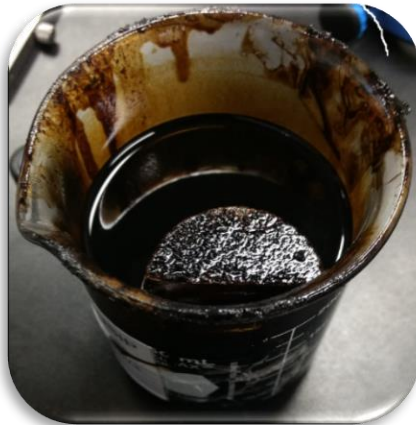
Figura 36. Núcleo sumergido en aceite para evitar el drene de fluidos previamente inyectados.
