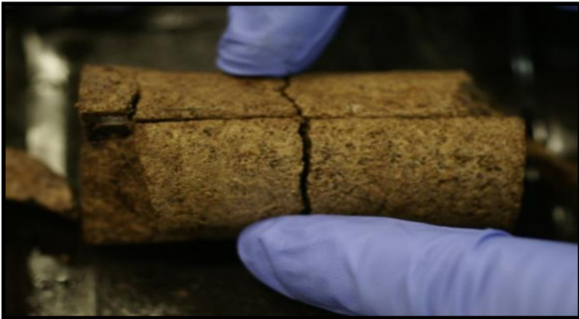
Figura 41. Estructura del núcleo después del confinamiento.
