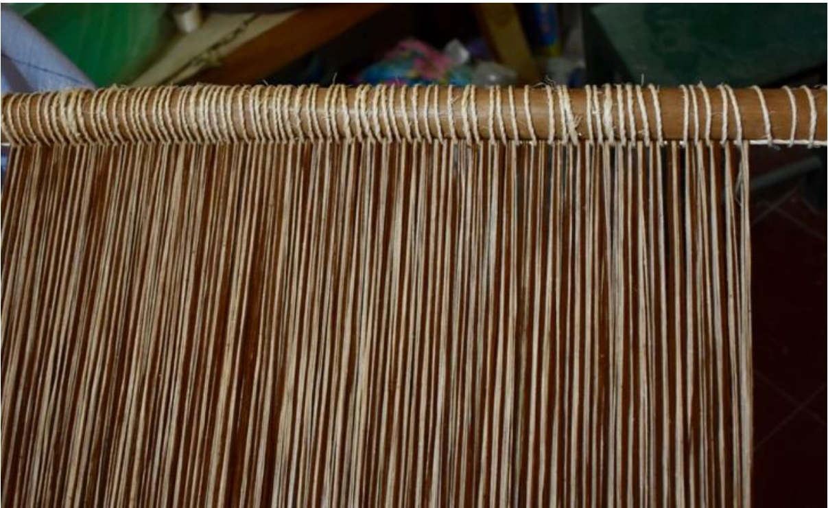
Fig. 17. Colocación de urdimbre en los julios o dux ire' . Fotografía de Ariadna Solis.
