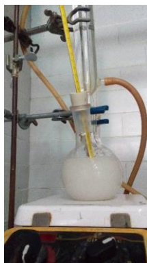
Figura 3.6. Equipo de reflujo para la preparación del disolvente MAC-141®
