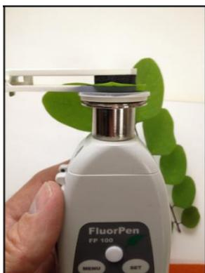
Figura 2. Ensamble de la pinza de hoja al fluorómetro “FluorPen FP 100”.
