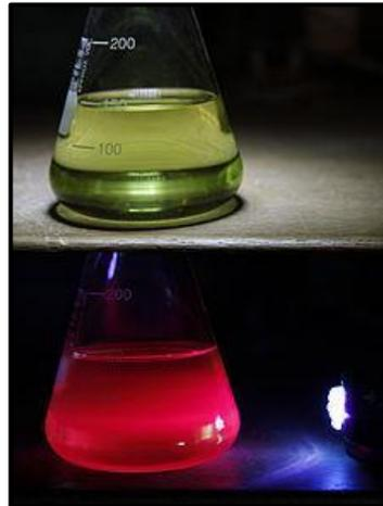
**Figura 5. Emisión de fluorescencia en un extracto de clorofila.**
