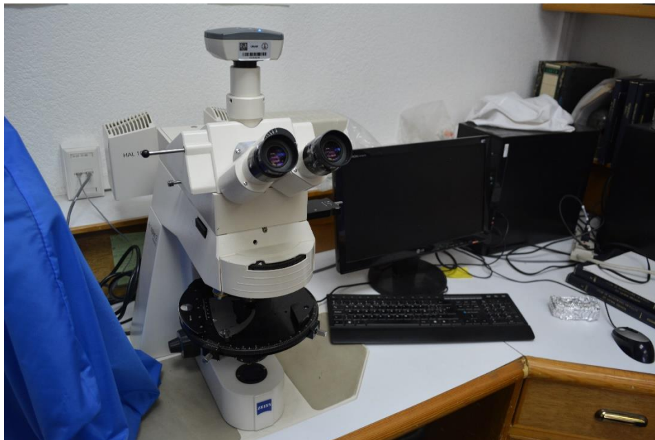
Fig. 10.- Microscopio petrográfico Carl Zeiss equipado con cámara conectada a una computadora para procesar y guardar imágenes.
