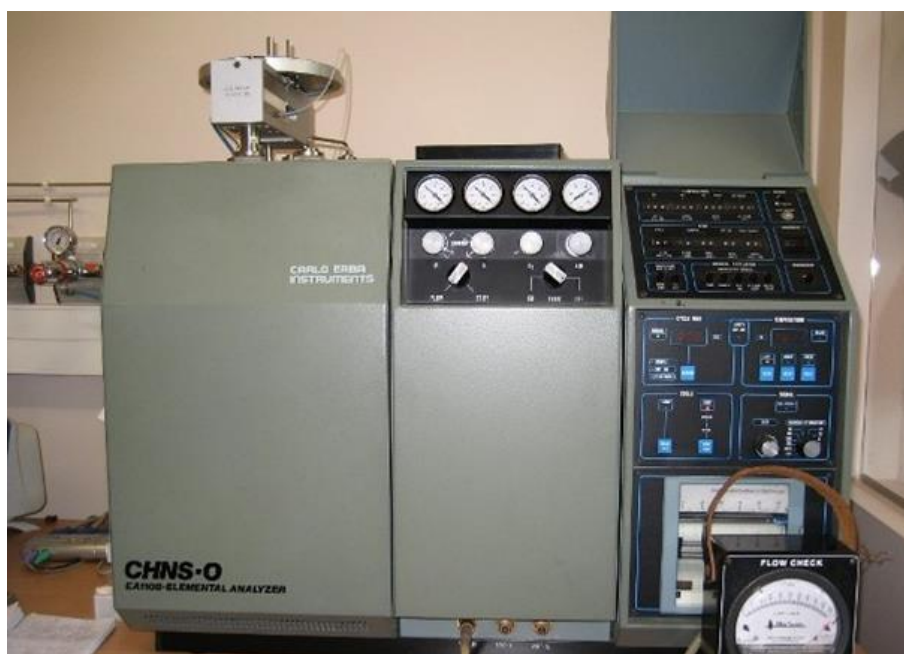
Fig. 13.- Espectrómetro de masas de flujo continuo Delta C Finnigan MAT con un analizador elemental TC-EA Carlo Erba 1108 acoplado (Figura representativa tomada de internet de la página UseScience).
