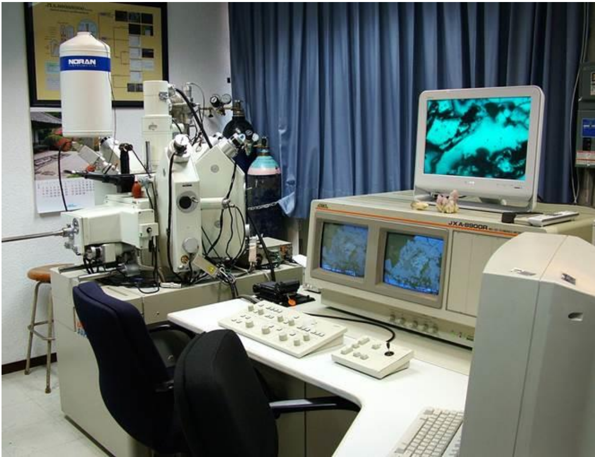
Fig. 14.- Microsonda electrónica de barrido marca JEOL modelo JXA8900-R (Fotografía cortesía de Carlos Linares).
