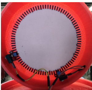
Figura 2.20: Cubrimiento de la salidas del haz de luz infrarroja de los módulos encoders y pintado del disco fotointerruptor a fin de asegurar la interrupción de dichos módulos encoder.
