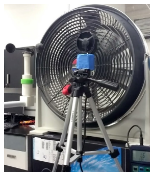
Figura 2.27: Determinación de velocidad de arranque del anemómetro.
