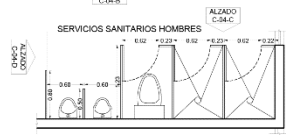
C-04 (PLANTAS) MAMPARAS EN SERVICIOS SANITARIOS PARA HOMBRES Y MUJERES EN AREA DE MANTENIMIENTO
