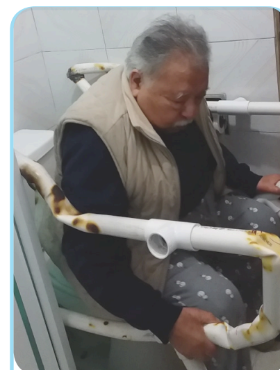
Prueba de postura del apoyo inferior para levantarse
