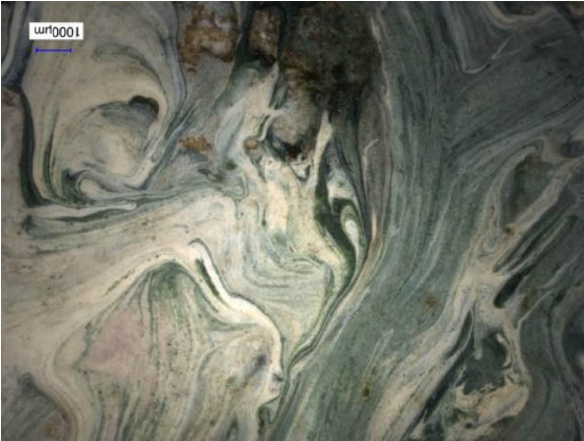
Fig. 272. Los iris y pupilas de la Fortaleza se lograron mediante colores muy líquidos mezclados en el muro. Se puede observar el uso de verde Viridian, negro de humo y blanco de zinc, posiblemente también un ocre amarillo. Microscopía de superficie, 20X. Fotografía: © Eumelia Hernández Vázquez-Guadalupe García Pasquel, Sandra Zetina, LDOA-LANCIC IIE, UNAM.
