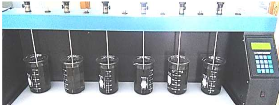
Figura 3.4 Equipo de Prueba de Jarras Phipps & Bird con panel digital y programación secuencial.
