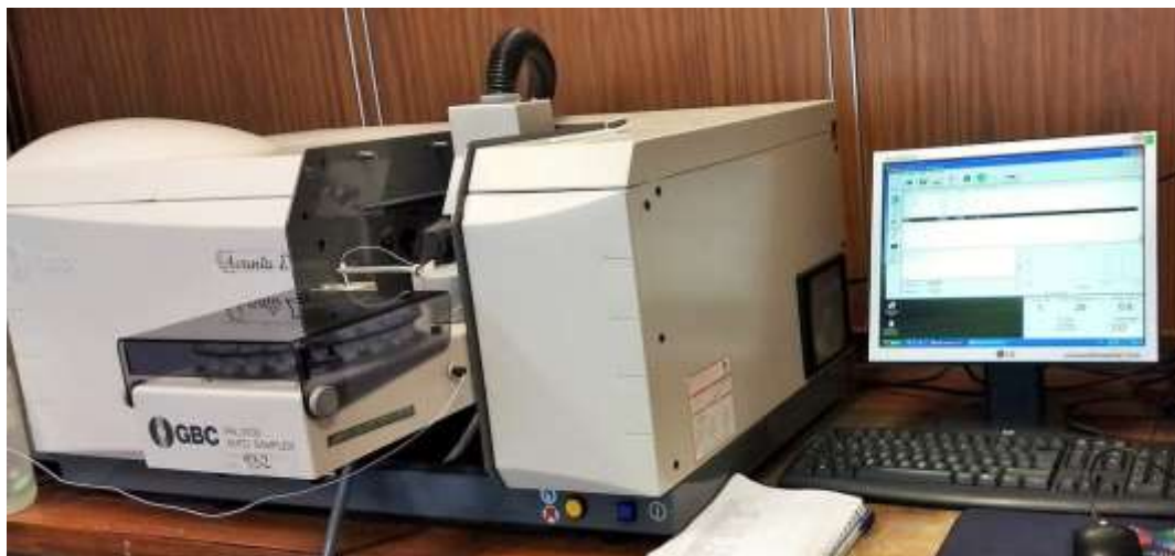
Figura 3.5 Espectrofotómetro de Absorción Atómica con Horno de Grafito marca GBC, modelo Avanta Σ.
