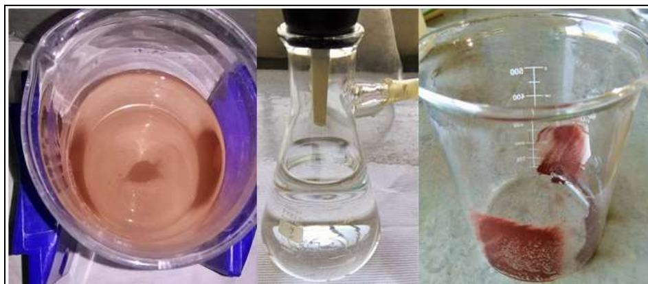
Figura 4.12 Sistema de separación y recuperación de las NPs. Aplicación de campo magnético – Filtración – Recuperación de NPs.
