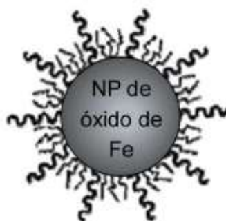
Figura 2.10 Modelo núcleo - recubrimiento de las nanopartículas de hierro.
