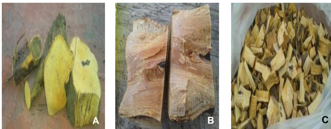
**Figura 8.1-1** Raíz de tejocote tras primer corte **(A)**. Raíz de tejocote, corte transversal **(B)**. Tamaño final de partícula **(C)**.
