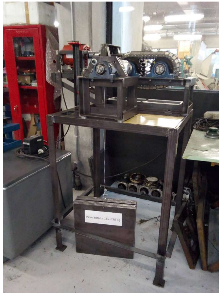
Vista general del banco de pruebas cuando el malacate levanta una carga de 1550 [N] (158 [kg]), y es impulsado por el RVTICR-2. En este caso el reductor opera con un tornillo de rodillos.
