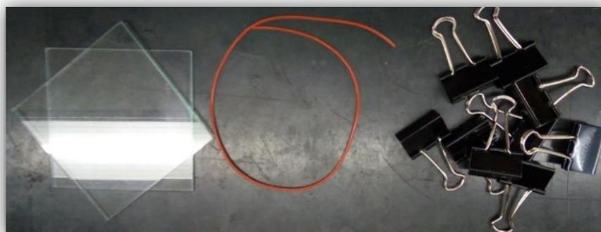
Figura 3. Celda de vidrio para reacciones en masa.
