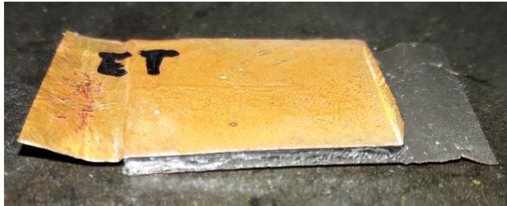
Figura 5. Placa del hidrogel con cinta de cobre para caracterización electroquímica.
