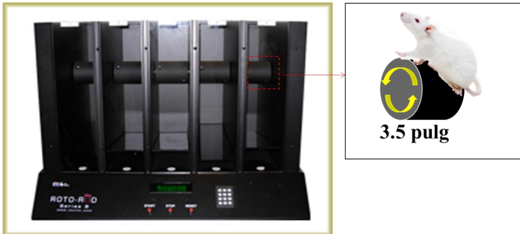
Figura 9. Rotarod IITC 755. Es un aparato automatizado con cinco compartimentos atravesados por un rodillo de 3.5 pulgadas, posee controles de velocidad que dispara el temporizador una vez que la rata cae en la varilla, la varilla gira a diferentes variaciones de aceleración (rpm) en un tiempo determinado (Bardullas et al., 2011).
