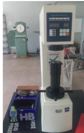
Fig. 5.2-3 Durómetro Brinell usado para realizar las indentaciones en las piezas.
