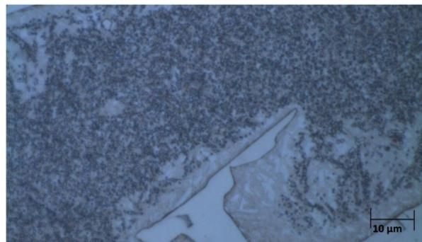
Fig. 5.3-3 Microestructura del componente 2 alta resolución (653 HBW en la superficie). Carburos eutécticos y matriz desestabilizada con alta densidad de precipitaciones.
