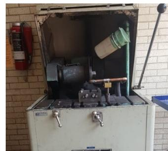
Fig. 5.1-5 Cortadora de banco con disco de SiC.
