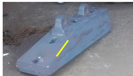
Fig. 5.3-1 Comp. 2 utilizado para las actividades reportadas en el apartado 5.3. Zona de extracción de la muestra señalada con una línea amarilla. A su lado la composición química en la olla (%peso).
