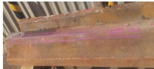
Fig. 5.1-1 Comp. 1 aleación ASTM A532 IIB condición de colada usado para las actividades experimentales de los apartados 5.1 y 5.2. A su lado la composición química en la olla (%peso).
