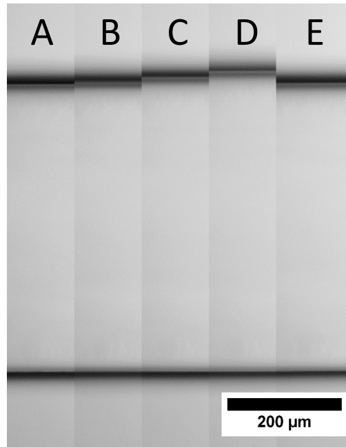
Fig. 4.10. Unión de 5 fotografías tomadas con microscopía óptica del perfil de un cilindro de vidrio recubierto de forma variable. Cada sección (A-E) está separada por una distancia promedio de 2 mm.
