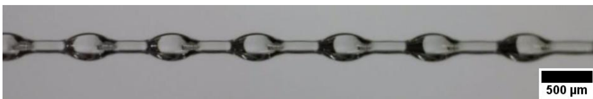
Fig. 4.6. Estructuras periódicas de PDMS formadas al recubrir una fibra óptica de 62.5 \mu\text{m} de radio a una velocidad de 300 \text{ mm/min} .
