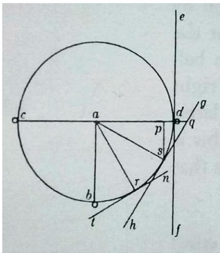
**Figura 20.** Planteamiento geométrico de los problemas de porqué y qué tanto más un cuerpo cae más rápido sobre una vertical que sobre un plano oblicuo. Se plantea también el problema del plano inclinado en términos de la palanca doblada (*De Motu*, XIV, 297).
