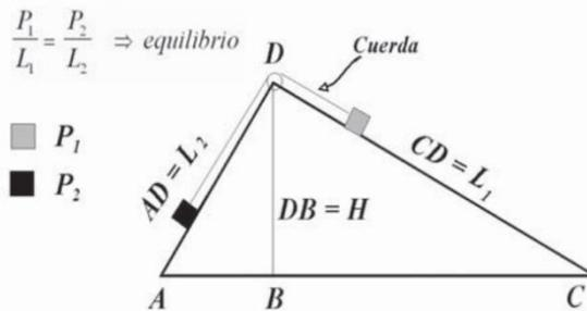
**Figura 11.** Planteamiento geométrico de la solución al problema del plano inclinado de Jordano (Vaccaro, 2008: 529).
