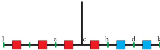
**Figura 5.** Paso uno de la demostración geométrica arquimediana del principio de la palanca (Damerow, McLaughlin y Renn, 2003: 48).
