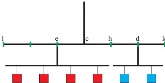
**Figura 6.** Paso dos de la demostración arquimediana del principio de la palanca (Damerow, McLaughlin y Renn, 2003: 48).
