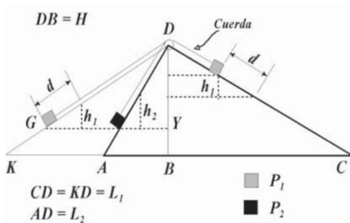
**Figura 12.** Planteamiento geométrico de la solución al problema del plano inclinado de Jordano (Vaccaro, 2008: 530).
