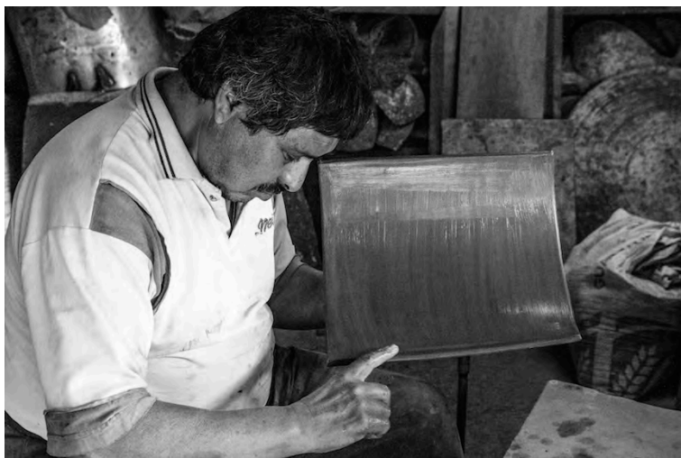
Figura 50. Salvador Hernández Cano alisando una pieza para preparar la superficie y aplicar engobes. Foto Ricardo S. Pareyón.
