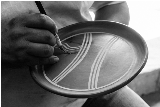
Figura 55. Proceso de bloqueo con barbotina, se ve el trabajo de Don José al realizar trazos con pincel de pelo de cola de ardilla, confeccionados por él. Se muestra el resultado final de la operación de bloqueo con barbotina. Foto Ricardo S. Pareyón.
