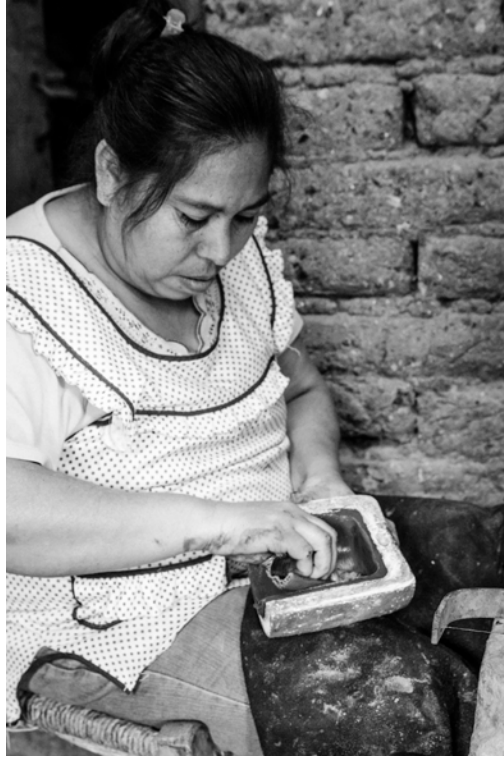
Figura 49. Proceso de conformación con moldes, en la imagen se ve a Martha Jurado Álvarez colocando una placa en un molde de yeso. Foto Ricardo S. Pareyón.
