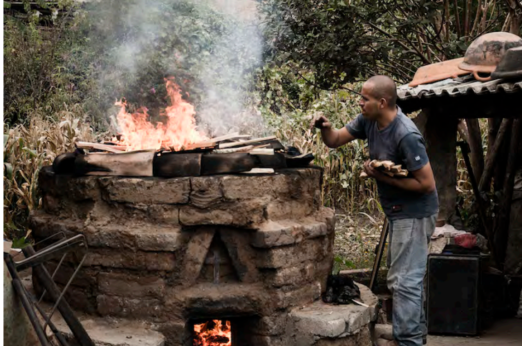
Figura 53. Primera cocción en horno de tiro, Ventura Hernández alimenta el horno con combustible para elevar y mantener la temperatura. Foto Ricardo S. Pareyón.
