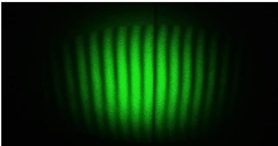
*Figura 1.13 Patrón de interferencia observado sobre una pantalla debió a la superposición de dos ondas, visto desde un cierto ángulo.*
