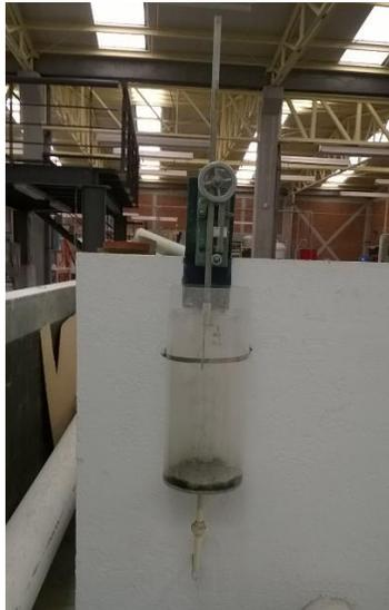
Fotografía 1.13 Limnómetro empleado para aforar el caudal
