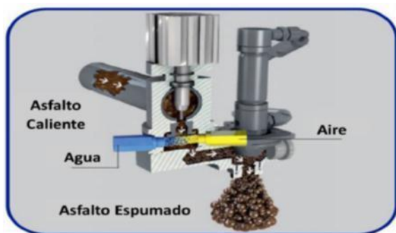
Figura 3.9.- Obtención del asfalto espumado
