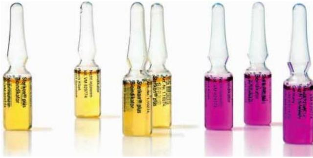
Fig. 4.5.1 Bioindicador Sterikon® para comprobar el funcionamiento de autoclaves (15 minutos a 121 °C). (tomada de <https://goo.gl/8xJcw3>)
