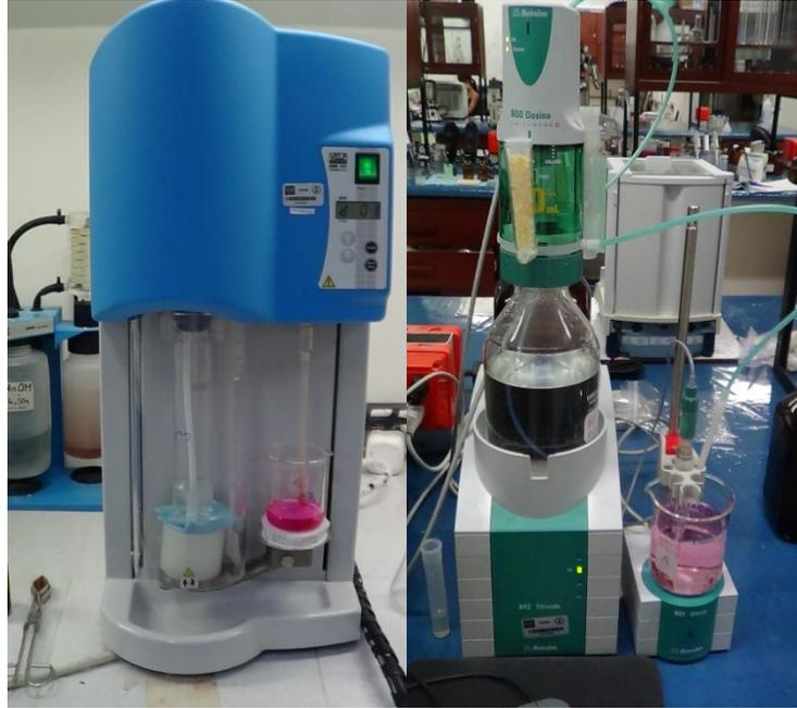
Figura 5. Equipo micro Kjeldahl. Obtención de proteínas totales en muestras del alimento y en el tejido de los peces al final de experimento.
