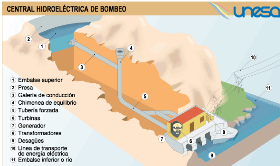
Figura 154 Partes de una central hidroeléctrica con rebombeo
