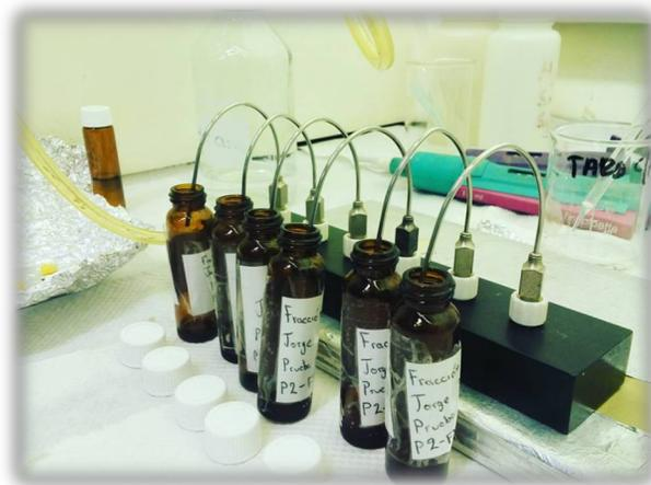
**FIGURA 8. SECADO DE LOS EXTRACTOS BAJO FLUJO DE NITRÓGENO**
