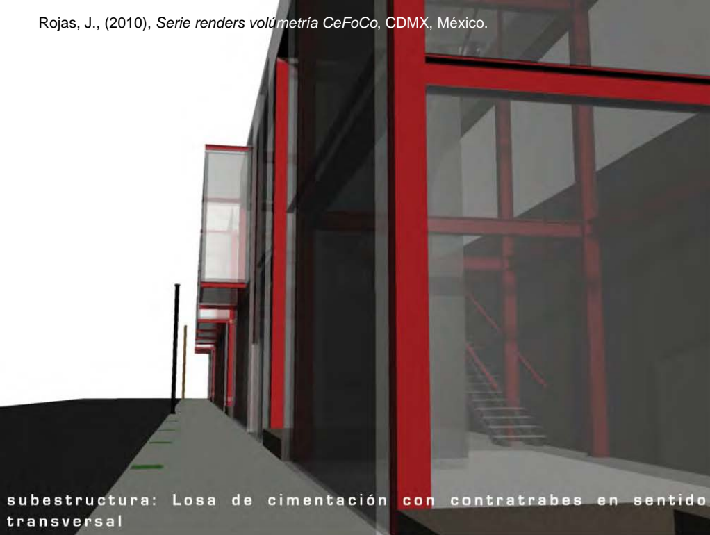
superestructura: columnas y vigas "I" 25.4x20.3
