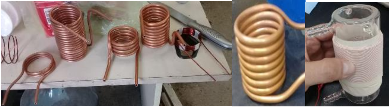
Figura 39. Bobinas fabricadas con tubo de cobre de 5/16 de pulgada, de izquierda a derecha se enlistan las bobinas de N=3, N=18, N=5, N=10, N=10 hecha de alambre magneto AWG 12, N=8 hecha de con tubo de cobre de 5/16 de pulgada y N=200 hecha de cable de Litz #4 255S.
