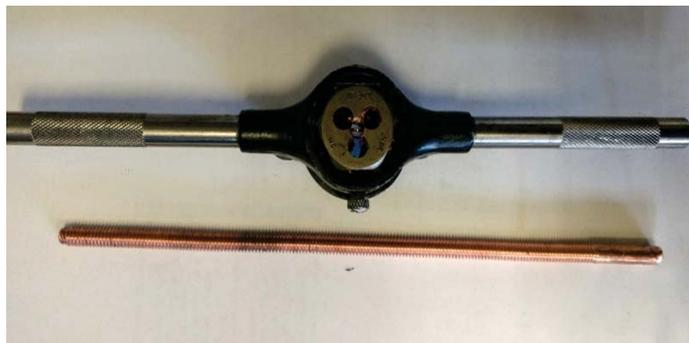
Figura 3.12: Machuelo y barra de cobre.
