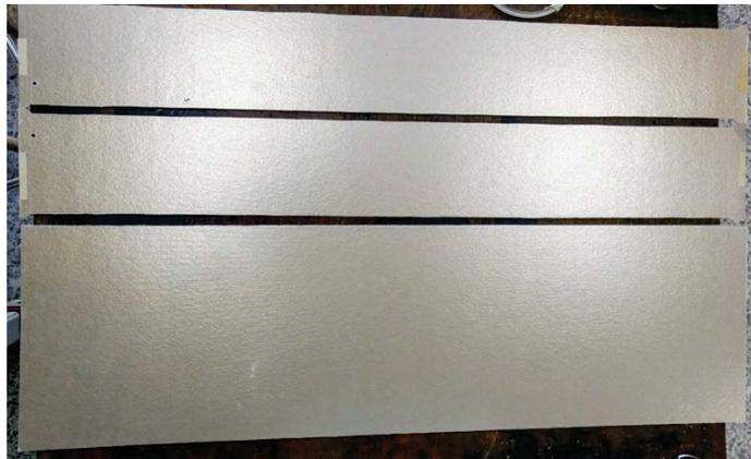
Figura 3.2: Cortes en la mica aislante.
