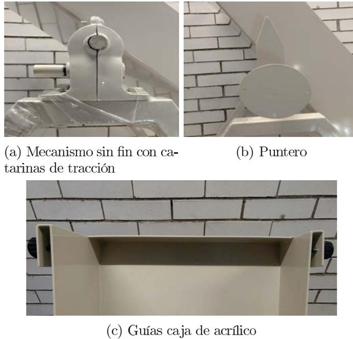
Figura 3.7: Complementos en la estructura de soporte.
