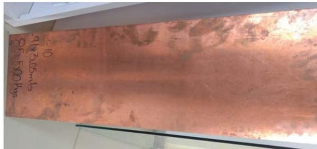
Figura 3.1: Placa de cobre sin modificaciones.
