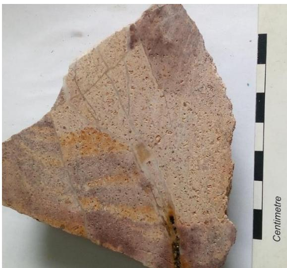
Roca ígnea con textura afanítica, leucocrática, matriz de grano fino color rosa [5Y 8/4] con fenocristales de cuarzo y posiblemente plagioclasa reemplazada por arcillas, diseminación de sulfuros en la matriz. Presencia de tres pulsos diferentes de vetillas de cuarzo.
