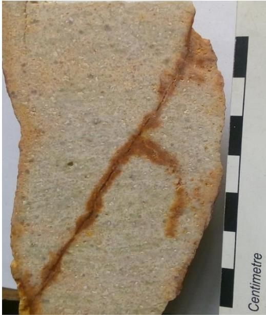
Roca ígnea, textura afanítica - fluidal, leucocrática, con matriz de grano fino, color rosa [10YR 8/2], se observa una ligera dirección de flujo de los cristales. Contiene fracturas oxidadas y vetillas de cuarzo.
