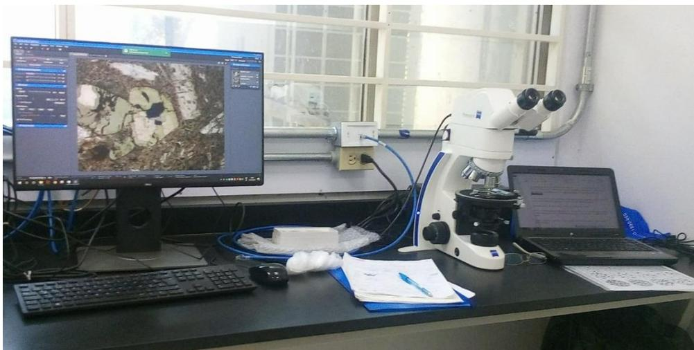
**Figura 9.** Microscopio Zeiss y software Zen que se utilizó para la toma de fotografías de las láminas delgadas.
