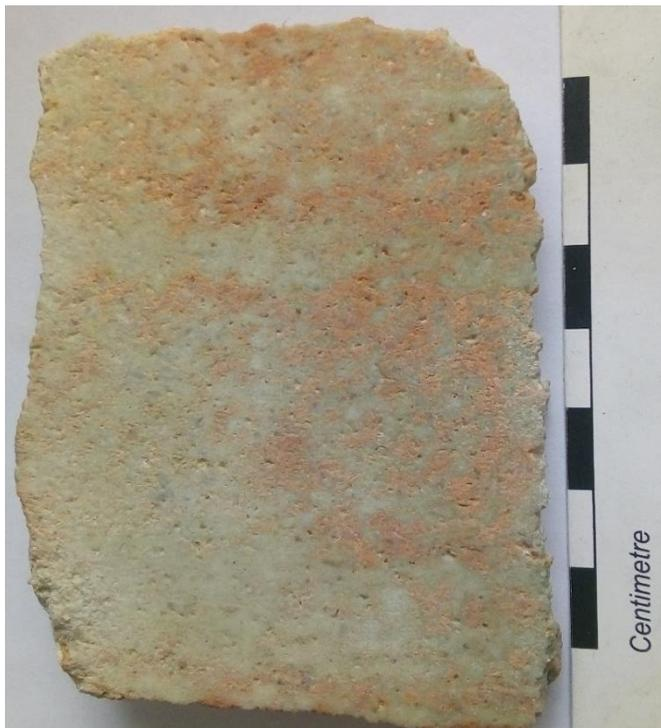
Roca ígnea, leucocrática, textura fanerítica y fluidal, de grano fino, matriz color verde claro [5Y 7/2], en las fracturas se observa oxidación. El bandeamiento de textura fluidal se compone principalmente por cuarzo y feldespatos.
