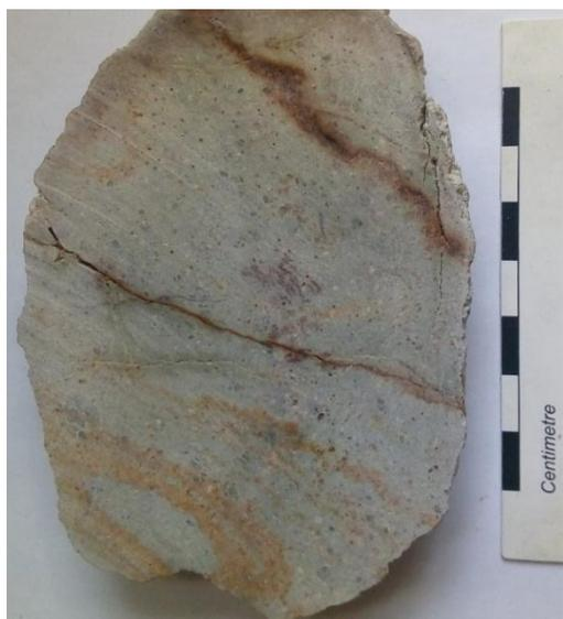
Roca ígnea con textura afanítica, leucocrática, matriz de grano muy fino color amarillo claro [5Y 6/4] con microfenocristales de cuarzo, plagioclasa y/o feldespatos con halos de alteración. Contenido de minerales opacos moderadamente oxidados, eudrales, cúbicos. Presencia de fracturas rellenas de cuarzo y óxidos.
