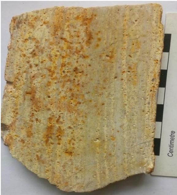
Roca ígnea, leucocrática, presenta textura fluidal, intercalación de franjas silicificadas y argilizadas. Matriz color beige de grano fino, con oxidación moderada, presenta fenocristales de cuarzo < 2mm. Contiene vetillas de cuarzo que cortan la textura casi perpendicularmente.
