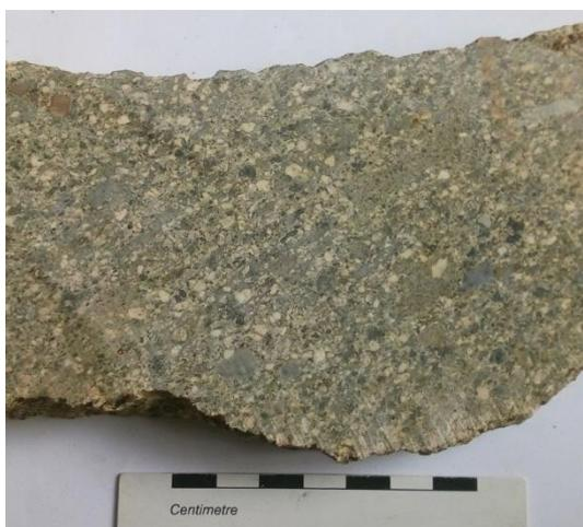
Roca ígnea, melanocrática con textura idiomórfica granular, color verde de grano medio a grueso, fenocristales de plagioclasa y feldespatos, no contiene cristales de cuarzo, contiene fragmentos de rocas redondeados, presenta un poco de oxidación entre los minerales.
