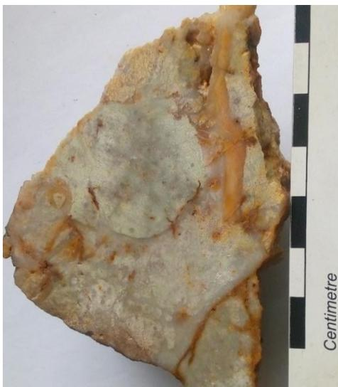
Roca fuertemente silicificada, leucocrática y levemente oxidada entre las vetillas de cuarzo criptocristalino. Pseudomorfos de plagioclasa reemplazados totalmente por montmorillonita, de 1 mm de longitud, contiene ojos de cuarzo de hasta 2 mm de diámetro.
