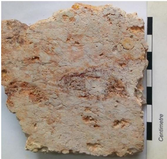
Roca ígnea, leucocrática, volcanoclástica, con fragmentos de roca redondeados, hasta 4 cm de longitud, reemplazados totalmente por arcillas, con matriz corroída y oxidada.
