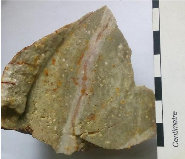
Roca ígnea, textura fanerítica, leucocrática, con fenocristales muy alterados por arcillas, matriz blanca con pirita diseminada, con vetillas de cuarzo < 5mm. Extremadamente fracturada.
