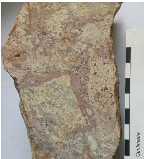
Roca leucocrática con fragmentos de roca angulares completamente alterados, silicificados y argilizados. Presenta esferulitas y oxidación entre las fracturas. Matriz completamente silicificada.
