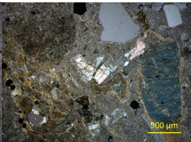
**Figura 75.** Matriz con fragmentos de cuarzo, feldespato, plagioclasa reemplazada en su totalidad por carbonatos, micas reemplazadas en su totalidad por clorita, opacos y fragmentos de roca. Aumento 5x, LPNA y LPA.
