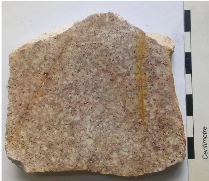
Roca ígnea, con textura porfídica, mesocrática, con matriz de grano fino color Rosa [5R 7/4], con fenocristales de grano medio, euedrales a subedrales, tabulares totalmente reemplazados por arcillas. Las fracturas presentan halos de oxidación probablemente óxidos de hierro y con presencia de arcillas. Algunos fenocristales reemplazados presentan un halo de alteración de arcillas.
