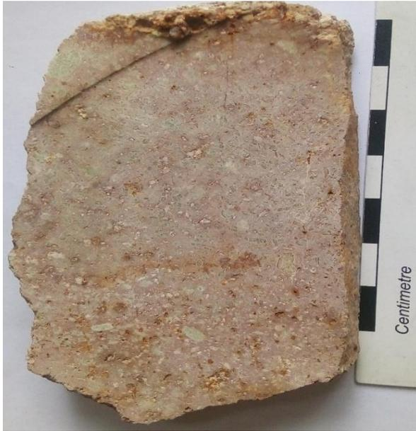
Roca ígnea, textura porfídica con matriz de grano fino color rosa [5R 7/4], mesocrática, matriz moderadamente oxidada. Contenido de fenocristales y microfenocristales de plagioclasa y piroxenos reemplazados totalmente por arcillas. Los minerales reemplazados presentan halos.
