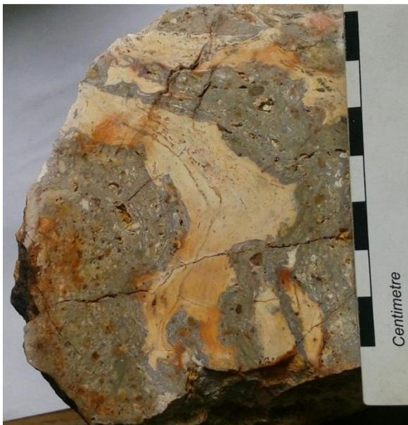
Roca volcanoclástica, textura fluidal, con bandas de cuarzo criptocristalino y arcillas. Fenocristales de ojos de cuarzo, pseudomorfos de plagioclasa reemplazados por arcillas y óxidos, líticos y minerales opacos ya oxidados.
