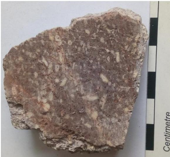
Roca ígnea, con textura porfídica, mesocrática, matriz de grano fino color vino [5R 2/6], con fenocristales de pseudomorfos blancos de plagioclasas reemplazadas por arcillas, no presenta vetillas. Extremadamente deleznable con agua, fracturas rellenas de arcillas, interconectada en los cristales.
